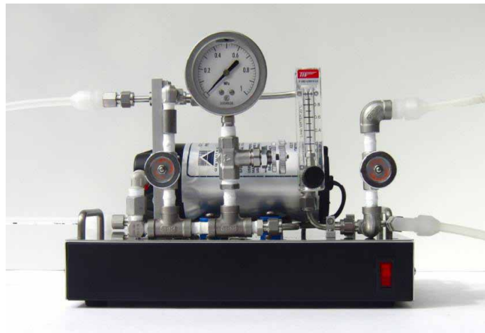
図6 卓上用平膜テスト装置
